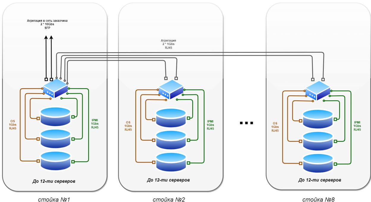
*Рисунок 6. Схема подключения серверных узлов для мониторинга текущего состояния Машины больших данных Скала<sup>Ар</sup> МБД8.АД*
