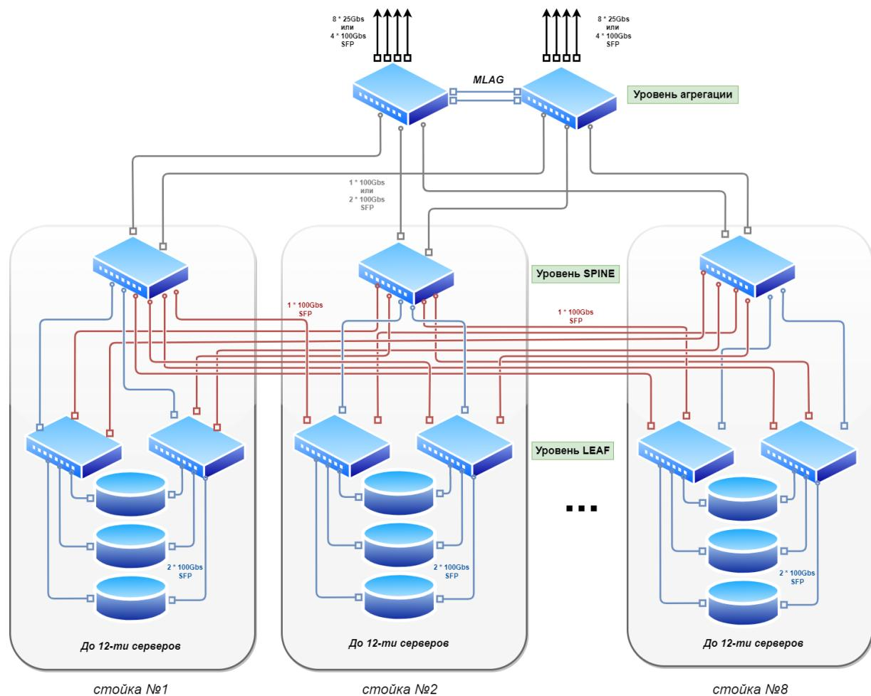
Рисунок 4. Схема организации интерконнекта Машины больших данных Скала^р МБД.Г
