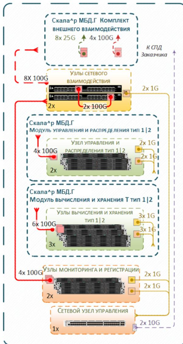
Рисунок 1. Общая структурная схема блоков модулей Машины больших данных Скала<sup>Г</sup> МБД.Г
