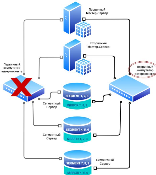
Рисунок 5. Схема работы интерконнекта Машины больших данных Скала^р МБД.Г при выходе из строя одного из коммутаторов
