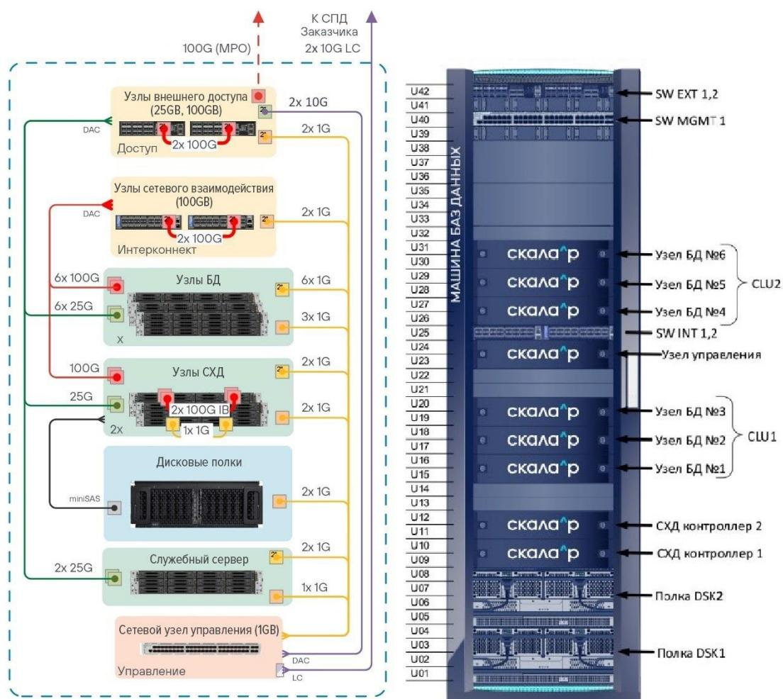
Рисунок 20. Схема взаимодействия для расчета надежности Машины баз данных Скала<sup>®</sup> МБД.П
