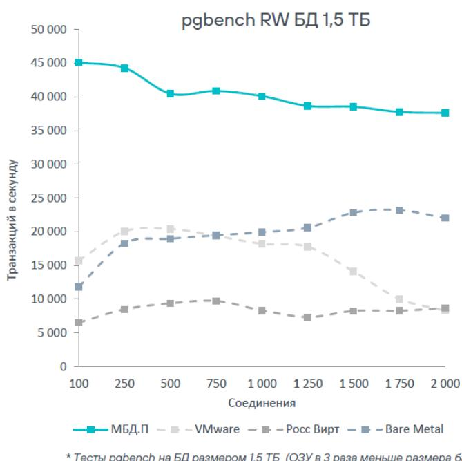
Рисунок 17. Скорость обработки запросов Машины баз данных Скала<sup>®</sup> МБД.П по результатам теста pgbench
