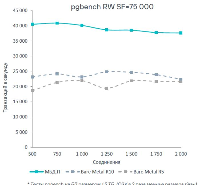
Рисунок 16. Производительность Машины баз данных Скала<sup>®</sup> МБД.П по результатам теста pgbench
