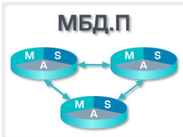
Рисунок 16. «Шахматное» размещение БД по узлам кластера
