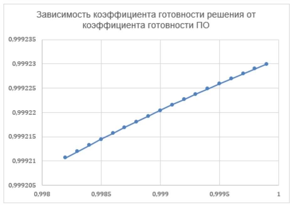
Рисунок 20. График зависимости вероятности отказа решения от коэффициента готовности комплекта программного обеспечения
