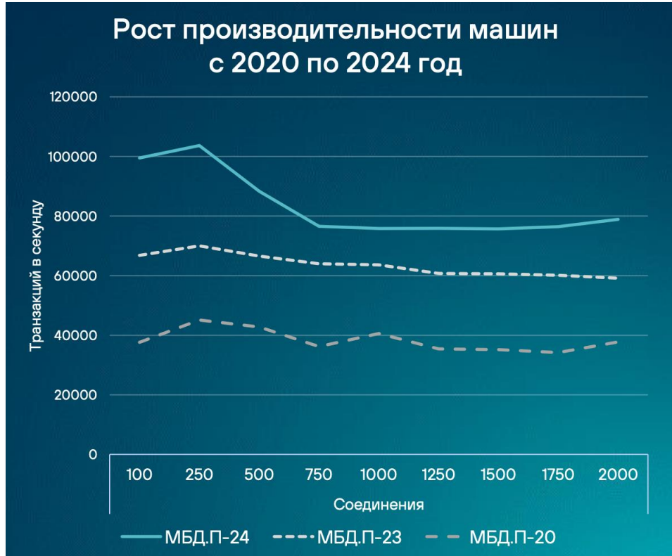
Рисунок 17. Производительность Машины баз данных Скала А р МБД.П по результатам теста pgbench
