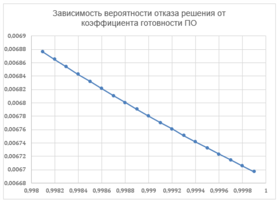
Рисунок 22. График зависимости вероятности отказа решения от коэффициента готовности программного обеспечения
