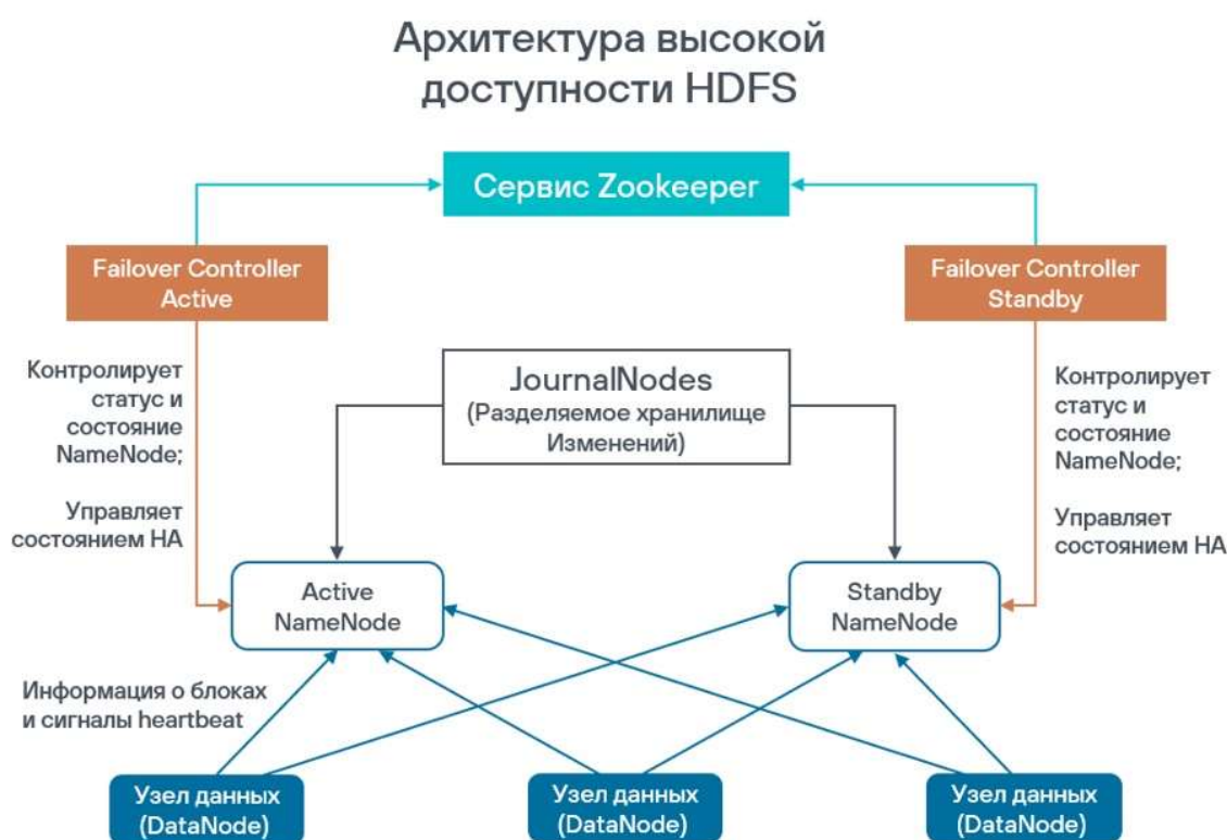
Рис. 2 Схема архитектуры высокой доступности HDFS
